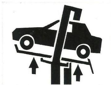
(9) Немедленно покиньте рабочую зону при возникновении опасности падения автомобиля
