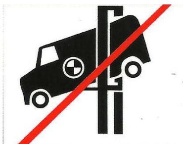
(11) Не раскачивайте автомобиль на подъемнике
